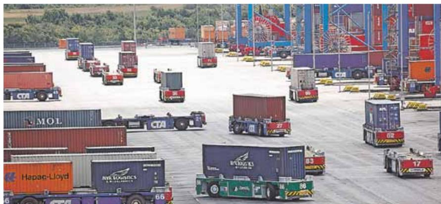
Containertransport mit Ökostrom. Auf dem HHLA-Containerterminal Altenwerder wurde der Prototyp des von Gottwald entwickelten batteriebetriebenen Containertransporters, das Fahrzeug mit der Nummer 86, im Flottenbetrieb erprobt (Foto: HHLA)
