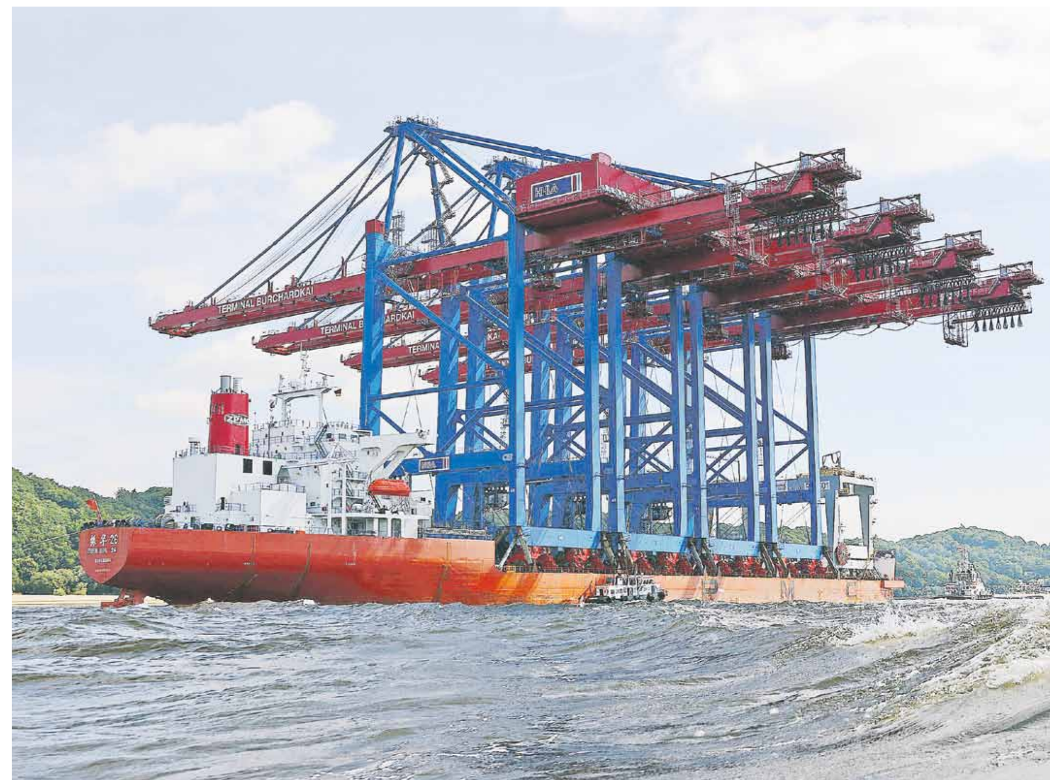
Dank der vier hochmodernen Tandembrücken wird der Container Terminal Burchardkai für die Abfertigung von Containerschiffen mit einer Stellplatzkapazität von 18.000 TEU gerüstet sein. (Foto: HHLA)
