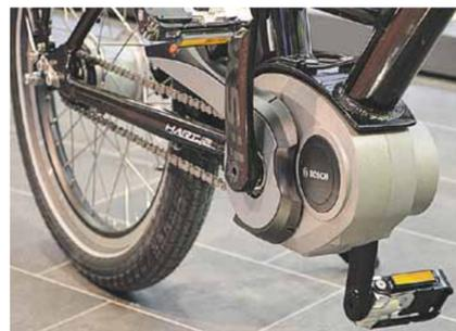
Das Herzstück eines Pedelecs – mit 250 Watt unterstützt dieser Motor je nach Einstellung das Fahrerlebnis leicht bis stark
